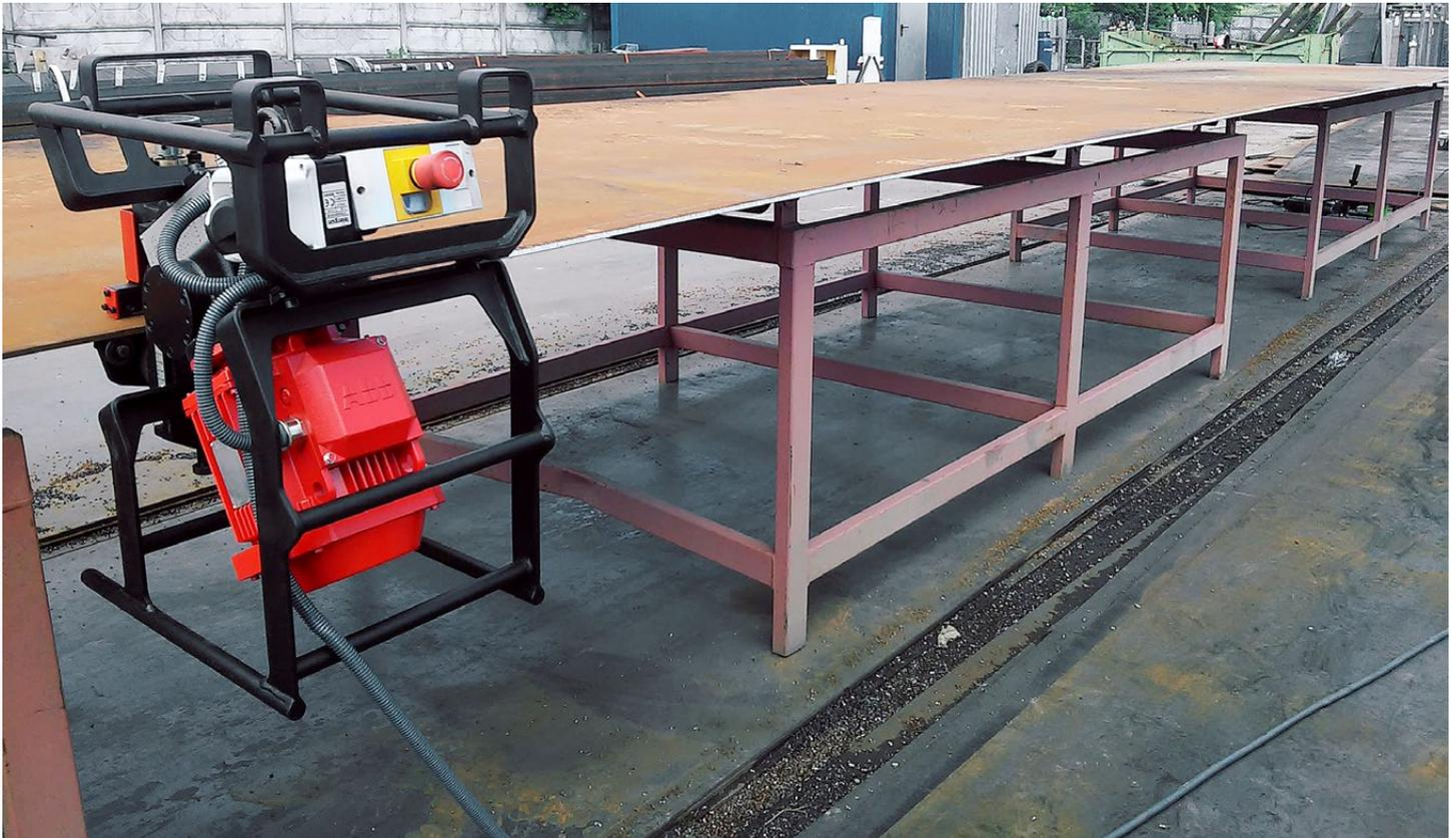
ABM-14 läuft automatisch an der Platte entlang
