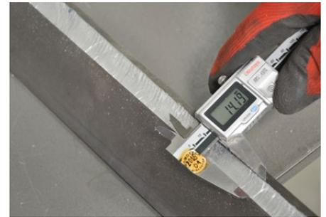
Maximale Fasenbreite bis 14 mm
