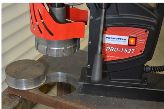
Foratura con frese a corona max 150 mm (5-7/8")
